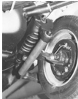
Los suplementos de amortiguadores se cambian sin desmontar la suspensión. Por ej. Audi 100
