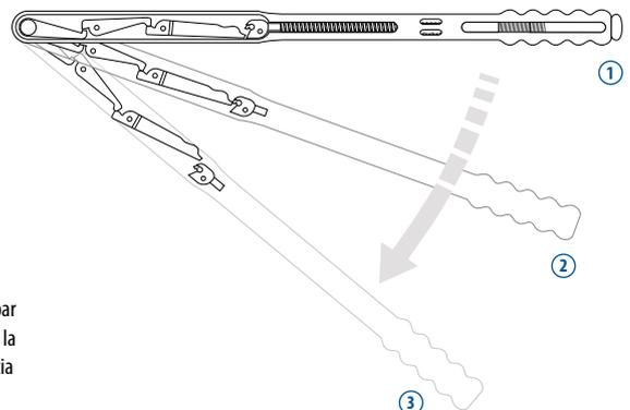
① Posición de la cadena de palanca sin efecto de fuerza (en posición normal).
